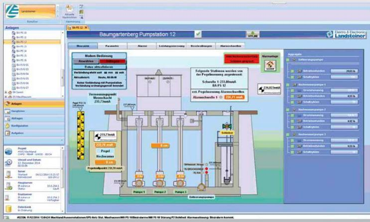
Alle Daten laufen im Leitsystem zusammen. Zur Erleichterung der Instandhaltung ist dort die elektronische Dokumentation sämtlicher B&R-Geräte hinterlegt. Zudem kann die lokale Visualisierung der einzelnen Stationen angezeigt werden.
